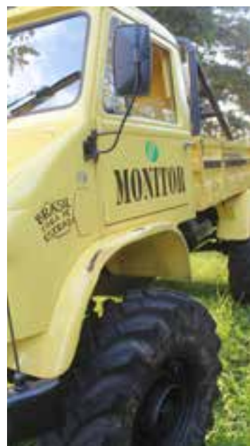
Note só ângulo de entrada desse pequeno titã. Equipado com motor MWM Sprint 4.2 turbo diesel e com uma das transmissões mais parrudas do planeta, O 404 pode, literalmente subir em paredes
