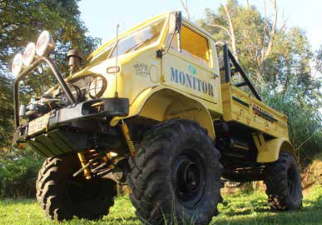
Note só ângulo de entrada desse pequeno titã. Equipado com motor MWM Sprint 4.2 turbo diesel e com uma das transmissões mais parrudas do planeta, O 404 pode, literalmente subir em paredes
