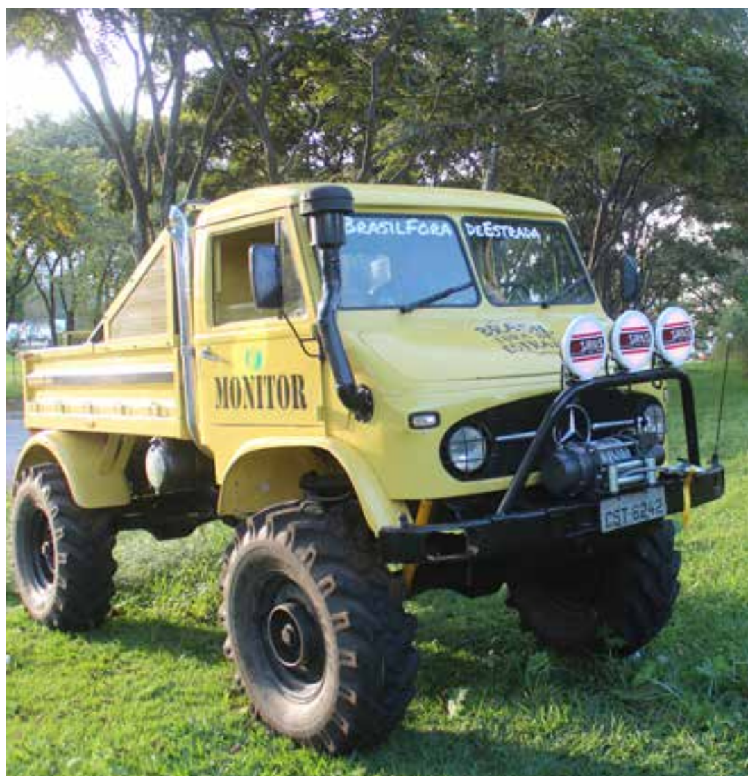
Note só ângulo de entrada desse pequeno titã. Equipado com motor MWM Sprint 4.2 turbo diesel e com uma das transmissões mais parrudas do planeta, O 404 pode, literalmente subir em paredes
